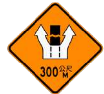
中間封閉 (前方 300 公尺處)
