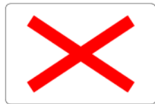
車道禁止進入
