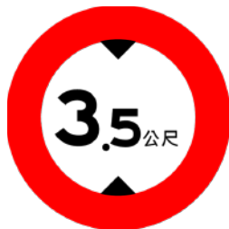
車輛高度限制標誌 告示車輛駕駛人通過前方道路結構物之高度限制，超限之車輛不准通行。
